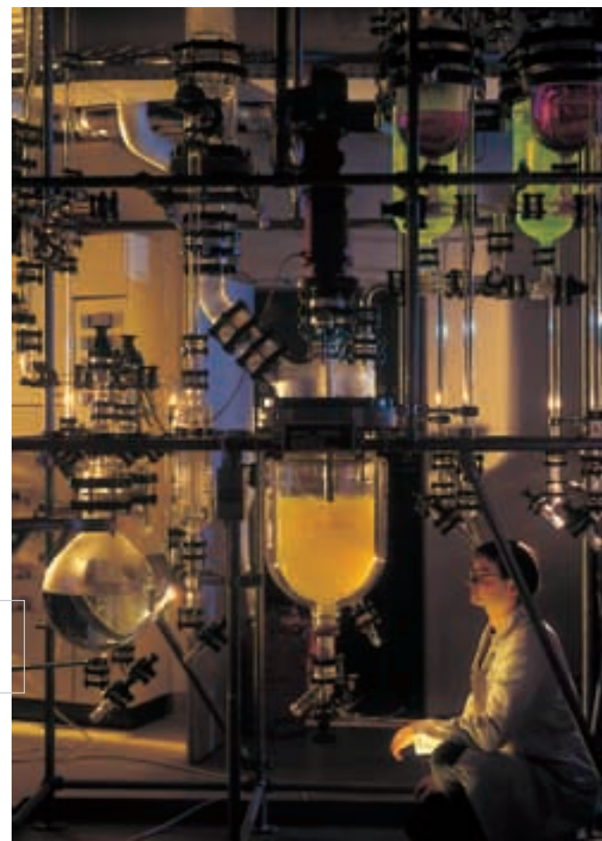
Κατάλληλος και για τα λεπτότερα σωματίδια: αντιδραστήρας σωματιδίων κολλοειδών διαλυμάτων/πηκτωμάτων.
