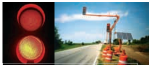
Η χρήση LED στους σηματοδότες εξοικονομεί χρόνο συντήρησης και ενέργεια. Ο χρόνος απόσβεσης είναι μόλις ένα έτος.
