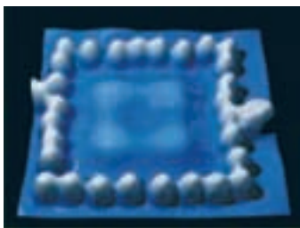
Μια νησίδα πυριτίου πάνω σε κρύσταλλο πυριτίου διαλύεται αργά στους 450 βαθμούς. Η γνώση των διεργασιών αυτών έχει σημασία για την ποιότητα των λεπτών στιβάδων.
