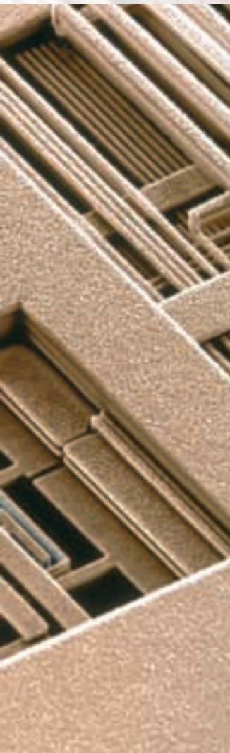
Σύνθετο όσο μια πόλη – τσιπ με εγχάρακτα κενά κυκλώματα συρμάτων χαλκού (IBM), σε εικόνα που έχει ληφθεί με ηλεκτρονικό μικροσκόπιο σάρωσης. Τα σύγχρονα τσιπ έχουν έως και 9 επίπεδα κυκλωμάτων.
