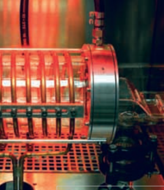
Αντιδραστήρες Aixtron για την έρευνα (αριστερά) και για τη κατασκευή ημιαγωγών σύνδεσης σε λεπτή στιβάδα με ακρίβεια ατόμου (δεξιά)
