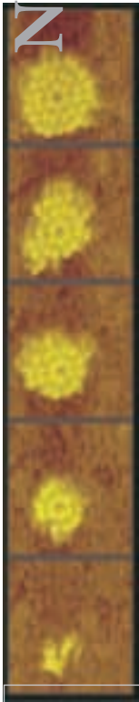
Μια νησίδα πυριτίου πάνω σε κρύσταλλο πυριτίου διαλύεται αργά στους 450 βαθμούς. Η γνώση των διεργασιών αυτών έχει σημασία για την ποιότητα των λεπτών στιβάδων.
